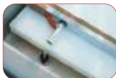
Barra de soldadura extraíble para facilitar limpieza.
